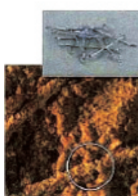
コンクリート中標準品 (従来品)の顕微鏡写真
