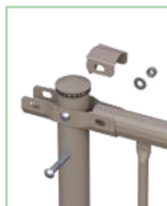
カバーの取付け
