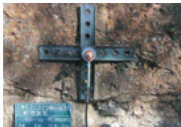
載荷試験状況(岩盤部)
