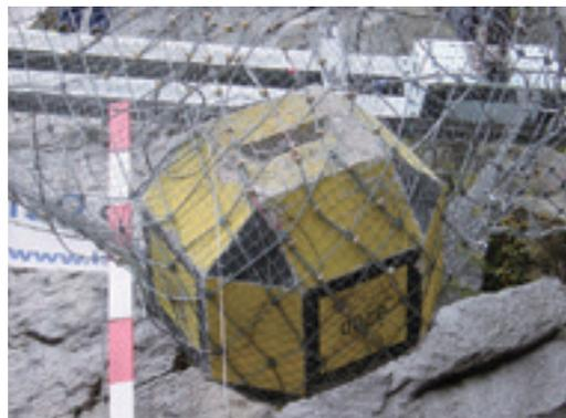
補修したネットで再度捕捉
