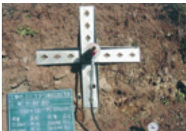
載荷試験状況(土砂部)
