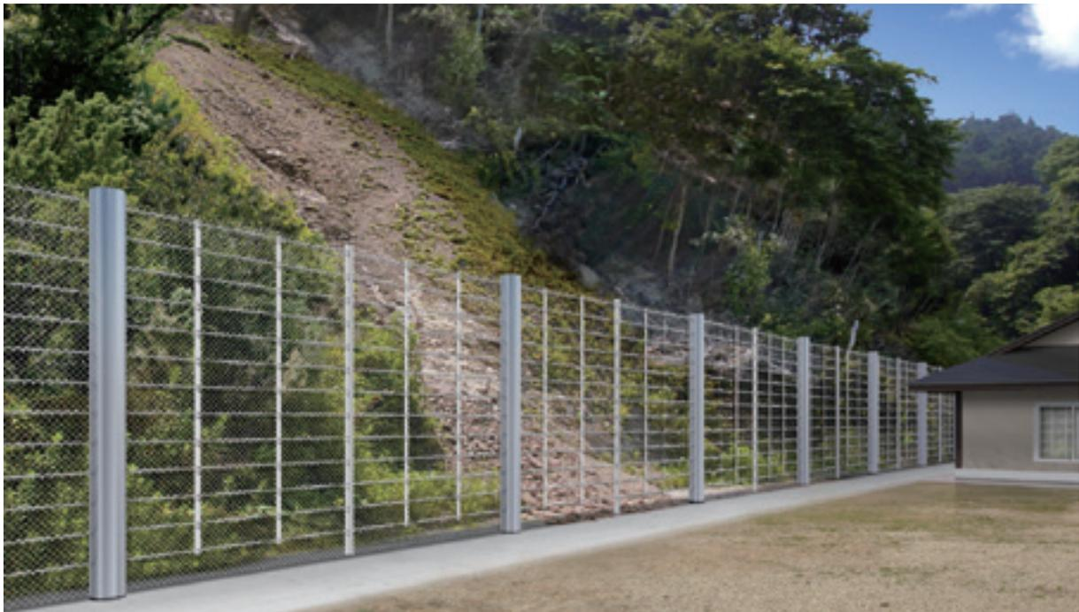
道路際に設置することができる「ロックディフェンス」は、二重鋼管構造により剛性を高めた支柱を使用し、衝撃吸収装置（テールブレーキ）や高強度金網（エクシードネット）・ワイヤロープを組み合わせることにより、落石エネルギーは500 kJ程度まで、崩壊土砂衝撃力は150 kN/m<sup>2</sup>（落石・土砂兼用仕様のみ）に対応することが可能です。本製品の施工には特殊な技能は不要で、一般的な落石防止柵相当の工程で設置が可能です。
