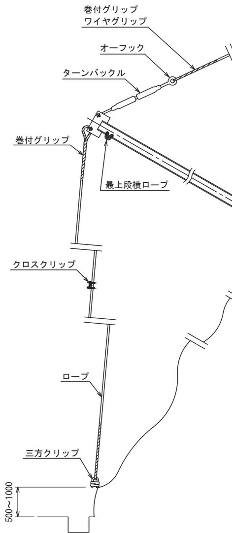
※吊ロープ、横ロープの巻付グリップ部に、1箇所当りに2個のワイヤグリップを併用する。
