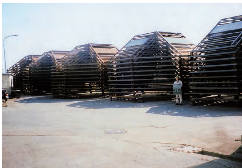
陸上仮置時・海上運搬時に段積みが可能
