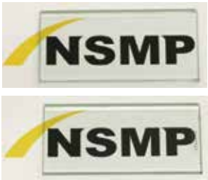
上:暴露前 下:促進暴露5,000時間後
