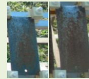
亜鉛・アルミ合金めっき(350g/m 2 )のみ
