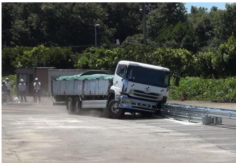
写真-7 大型車衝突試験による性能確認
