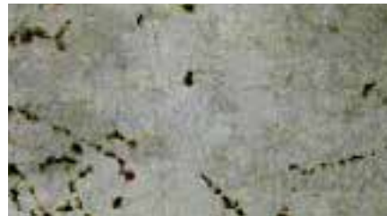
普通セメント+ドラミックス標準品 (16 サイクル後)
